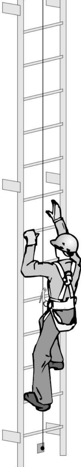
escalera fija >7 m.
